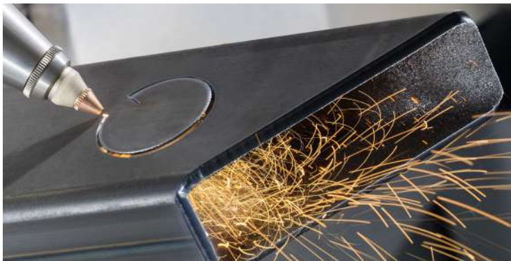
▶ Taglio e cianfrinatura di un tubolare rettangolare
